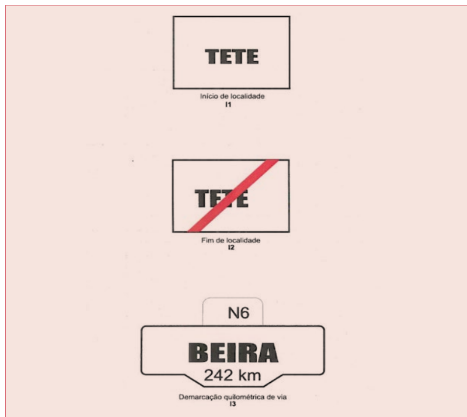
Figura 10-6. Sinais de identificação de localidades e de estradas.
